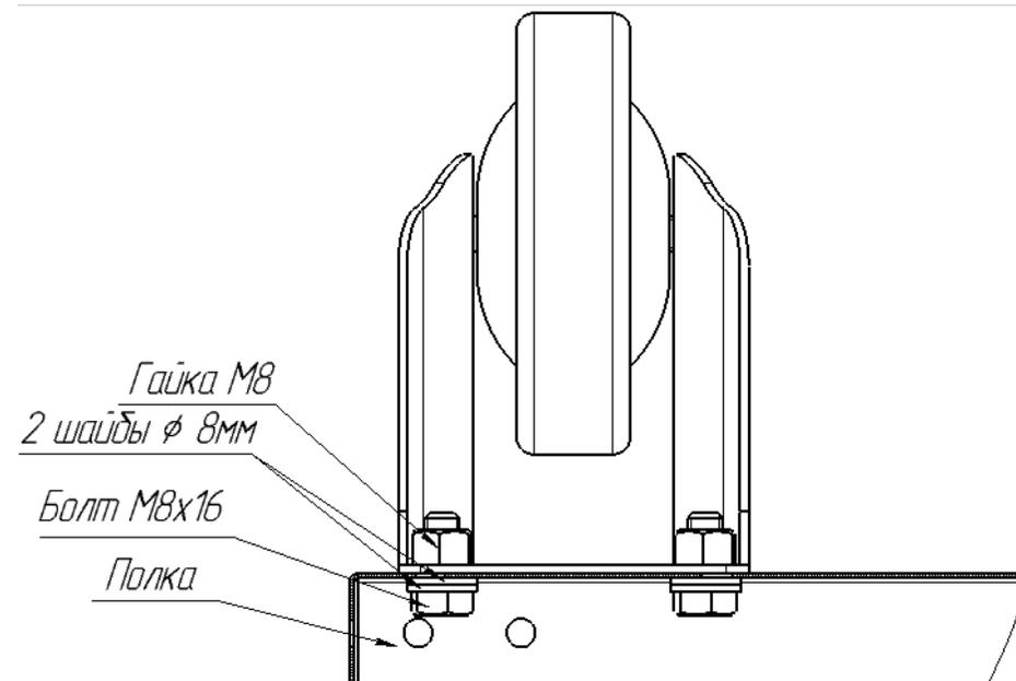
**5.2.** Соединить стойки(3) и полки(1),(2) между собой, установить ручку, согласно рисунку:
