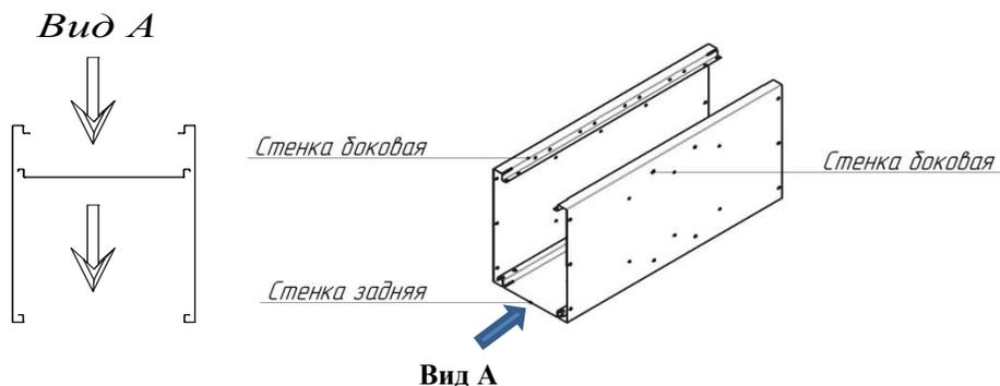
6.2.2. Установить крышу. Если вы приобрели шкаф односекционный, приклепать крышу нужно к двум боковым стенкам. Если у вас шкаф состоит из двух и более секций нужно приклепать крышу только к одной из боковин (на рис. 6а-окрашена) и задней стенке (Рис.6а и Рис.6б).
